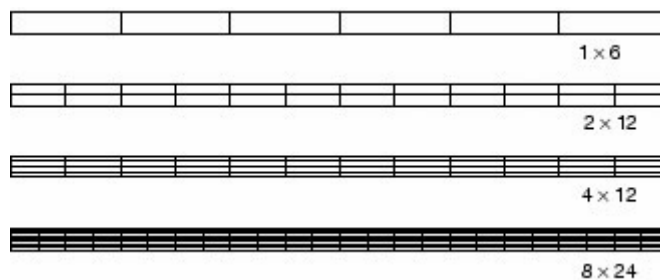
图 4-3 悬臂梁模拟所采用的网格
